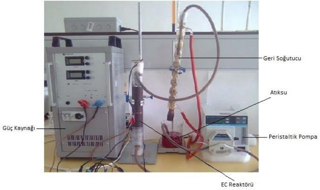
Şekil 7.1. Reaktif kırmızı boyarmaddesi ile yapılan deneylerde kullanılan düzenek
