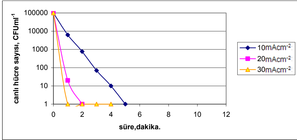
Şekil 7.2. İridyum metal oksit elektrotların akım yoğunluğunun hücre hayatta kalma oranına etkisi
