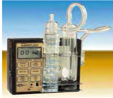
Şekil 4.7. Impinger Kullanılarak Oluşturulmuş Aktif Örnekleme Düzeneği Örneği [35]
