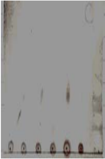
Şekil 3.6. Plak üzerine Moybdenum Blue reagent spreylendikten sonra oluşan mavi renkli spotlar fosfolipidler ( H. volcani , H. hispanica , H. borinquense , Halobacterium spp., 44 ve 54)
