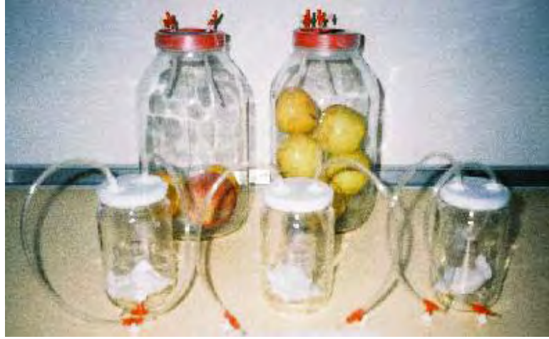
Şekil 7.2. Sivas, Bigadiç ve Gördes yöresine ait doğal zeolitlerde etilen adsorpsiyonuna ait deney düzeneği
