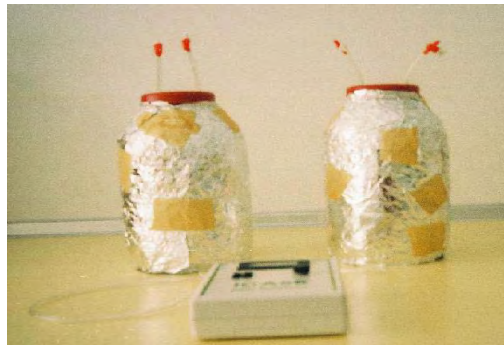
Şekil 7.1. Zeolit-elma ve KMnO_4 -elma ortamındaki etilen adsorpsiyonuna ilişkin deney düzeneği
