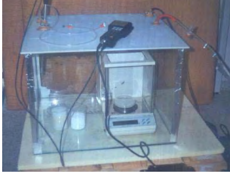
Şekil 7.3. Etilen adsorpsiyonuna ilişkin gravimetrik ölçümlerin yapıldığı deney düzeneği
