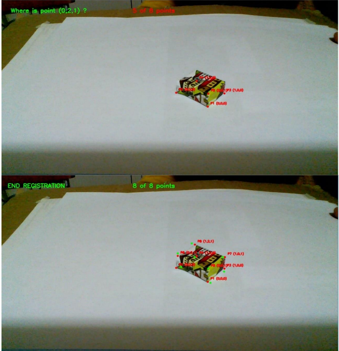
Görsel 3.3. Fare ile Köşe Noktaları Tıklayarak Nesne Kayıt İşleminin Ekran Görüntüsü. (Kırmızı noktalar işaretlenen noktaları, yeşil noktalar tahmin edilen nokta pozisyonları temsil etmektedir.)
