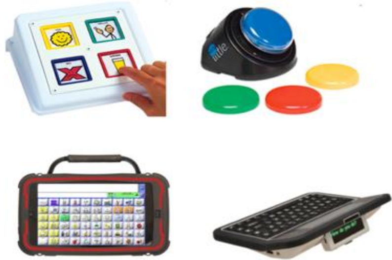
Görsel 1.2. Eski nesil sabit görünümlü konuşma üreten cihaz örnekleri
