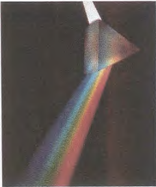
Resim 67., Güneş Işığının Prizmadan Renklere Ayrılarak Yansması
