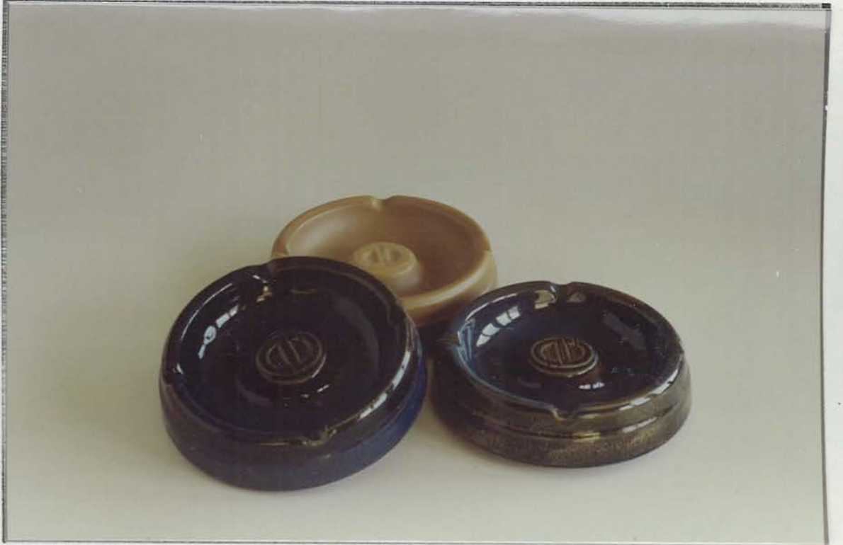
Resim 36: Çift cidarlı kül tablalarına değişik renkte sırların uygulanması. Çap 16cm. yükseklik 4,5cm.
