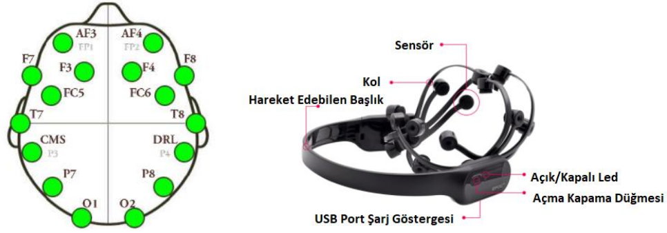
Görsel 4.3. Emotiv Epoc X elektrot yerleşimi (Sánchez-Reolid vd., 2018, s. 3) (solda) ve Emotiv Epoc X cihazı(sağda) (http-10)
