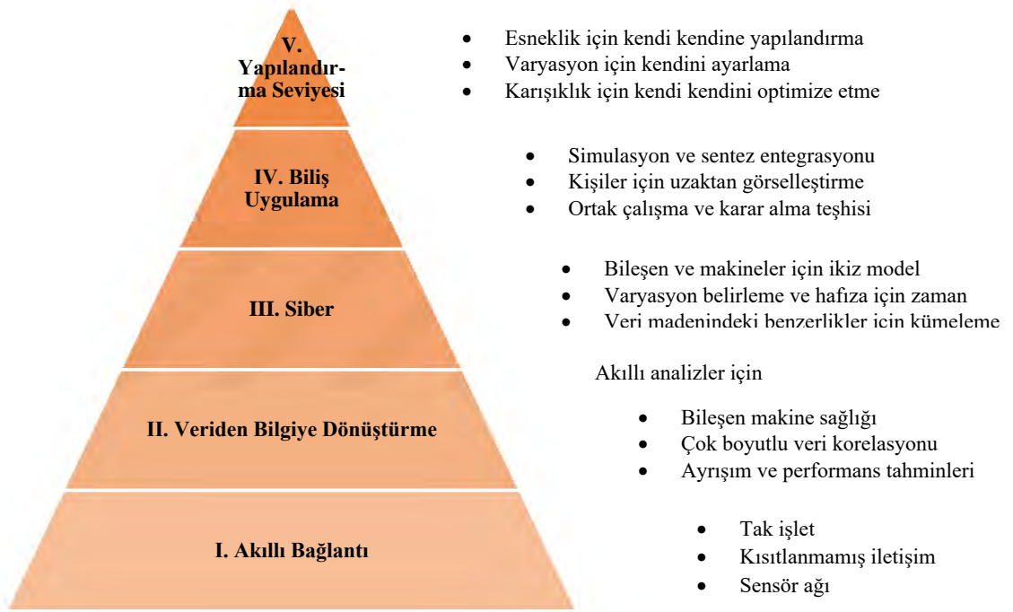
Şekil 1. 4. Üretimde siber fiziksel sistemler için 5C modeli (Lee vd., 2015, s.19)
