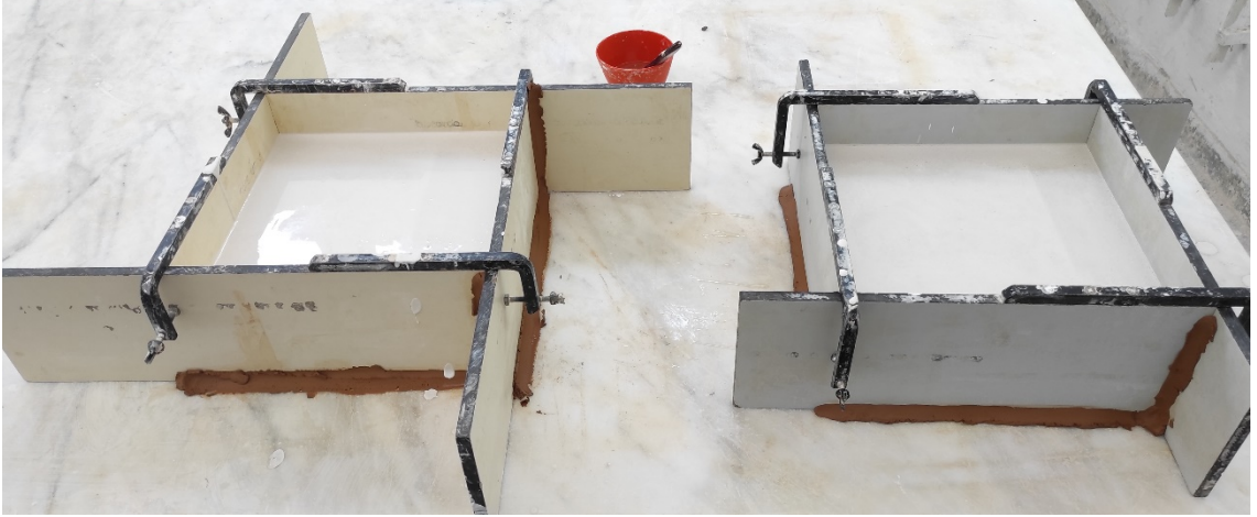
Görsel 3.32. Alçı bloklarının kurumaya bırakılması Ali Öncel fotoğraf arşivi
