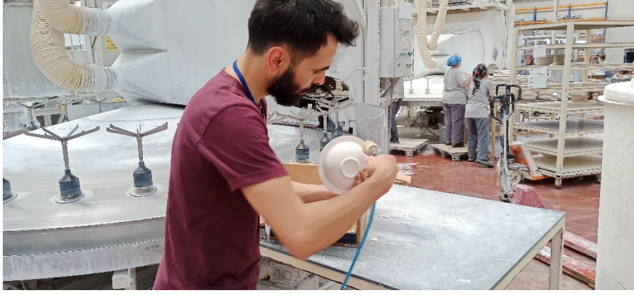
Görsel 3.102. Bisküvi ürünlerin sırlama öncesi pistole ile tozlarının alınması Ali Öncel fotoğraf arşivi
