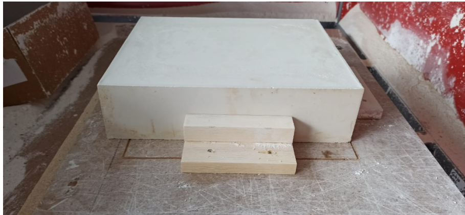
Görsel 3.61. Salata kasesi dişi kalıbın kazınması için sabitlenmiş alçı blok Ali Öncel fotoğraf arşivi
