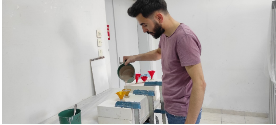
Görsel 3.84. Porselen döküm çamurunun kalıplara dökülme işlemi Ali Öncel fotoğraf arşivi
