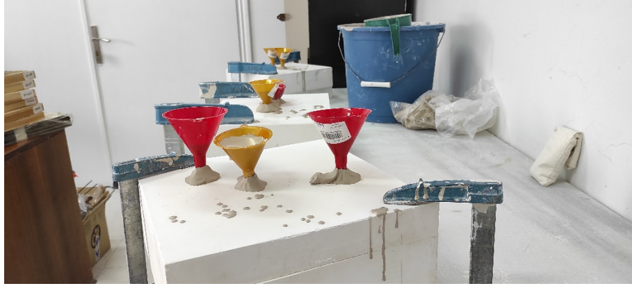
Görsel 3.85. Porselen döküm çamurunun dökümü Ali Öncel fotoğraf arşivi
