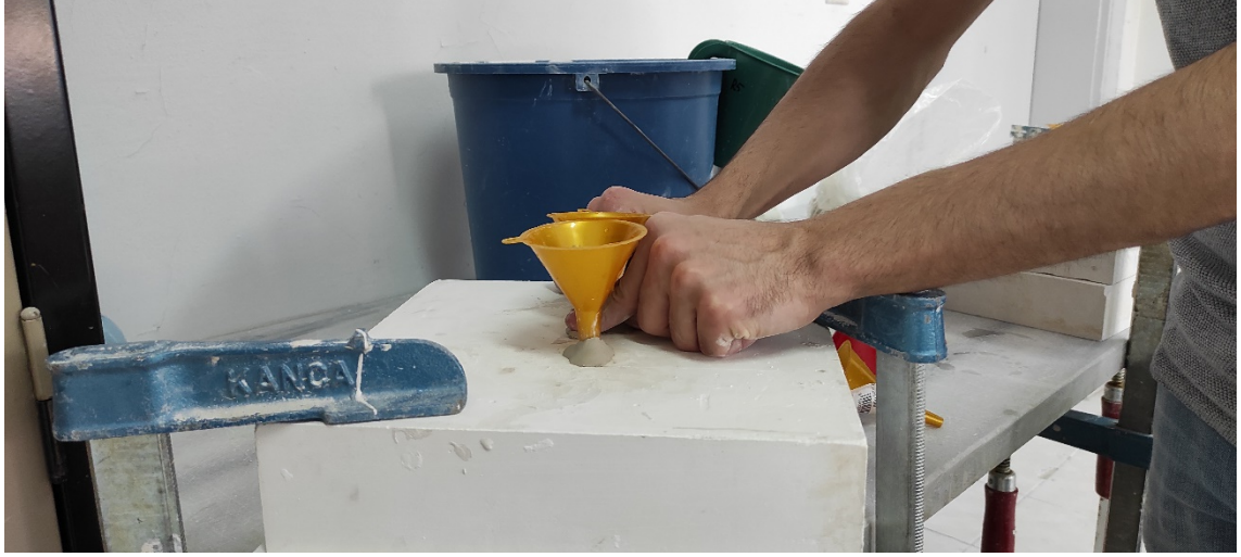
Görsel 3.82. Kalıpların sabitlenmesi ve döküm ağızlarının takılması Ali Öncel fotoğraf arşivi
