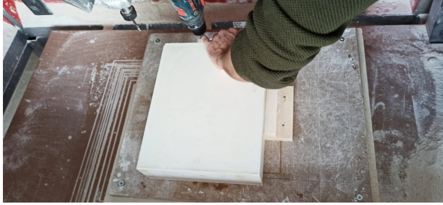
Görsel 3.74. Servis tabağı dişi kalıp için alçı blok sabitlenmesi Ali Öncel fotoğraf arşivi
