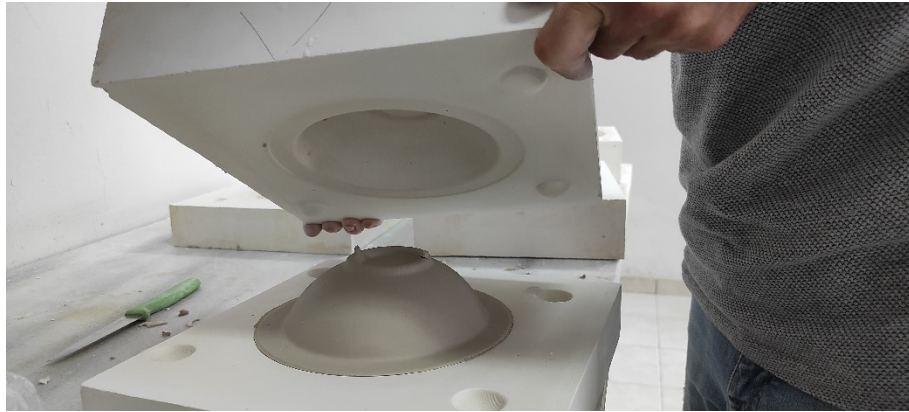
Görsel 3.88. Dökümden sonra çorba kasesi kalıbının açılması Ali Öncel fotoğraf arşivi
