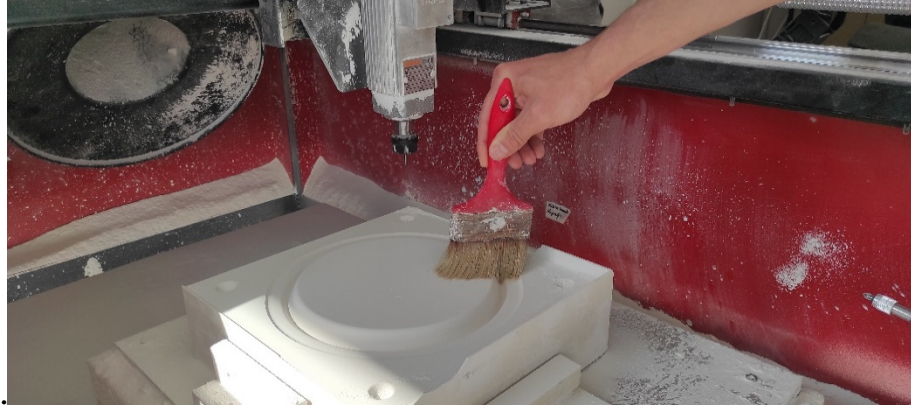
Görsel 3.71. Tamamlanan servis tabağı kalıbının üzerindeki biriken alçı tozunun süpürülmesi Ali Öncel fotoğraf arşivi
