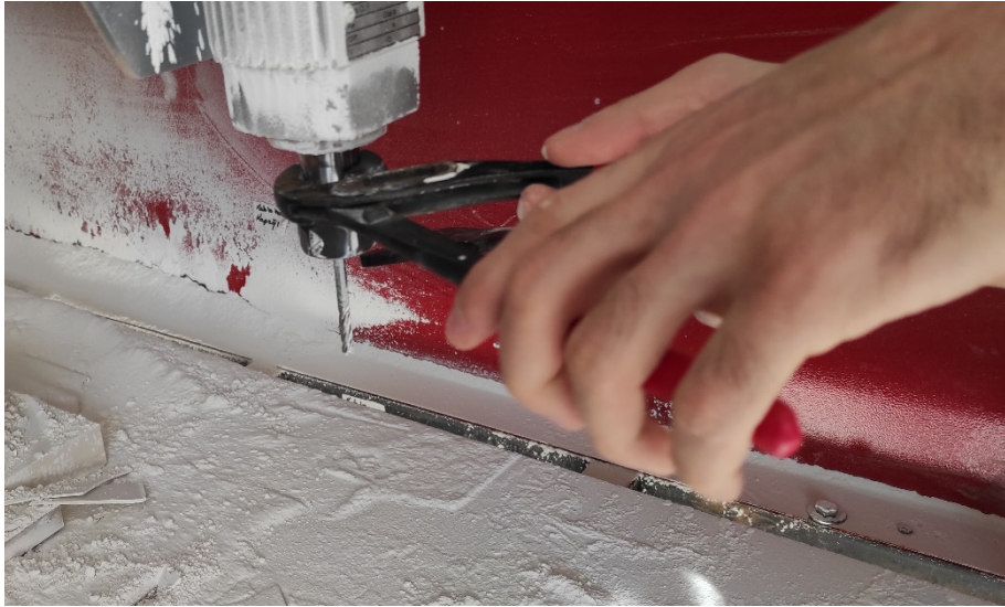
Görsel 3.40. Cnc freze ucun Spindle'a geçirildikten sonraki sıkma işlemi Ali Öncel fotoğraf arşivi
