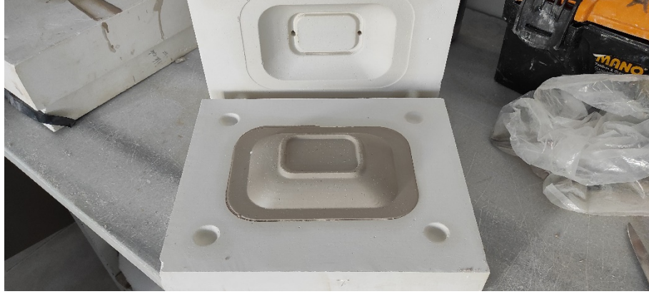
Görsel 3.89. Dökümden sonra salata kasesi kalıbının açılması Ali Öncel fotoğraf arşivi
