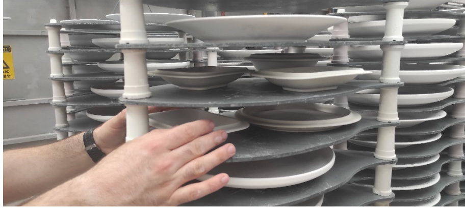
Görsel 3.105. Sırlanmış ürünlerin fırına yerleştirilmesi
