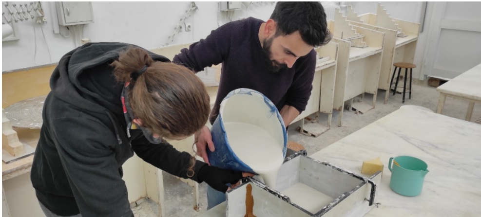
Görsel 3.31. 300mm x 300mm x 90mm boyutlarında alçı blok dökümü
