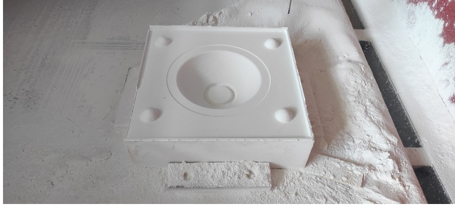
Görsel 3.55. İnce kazıma işlemi tamamlanmış çorba kasesi dişi kalıbı Ali Öncel fotoğraf arşivi
