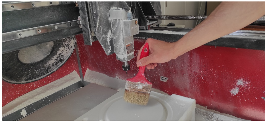
Görsel 3.70. Tamamlanan servis tabağı kalıbının üzerindeki biriken alçı tozunun süpürülmesi Ali Öncel fotoğraf arşivi
