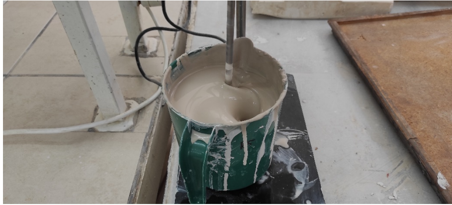
Görsel 3.83. Porselen döküm çamurunun karıştırılması Ali Öncel fotoğraf arşivi
