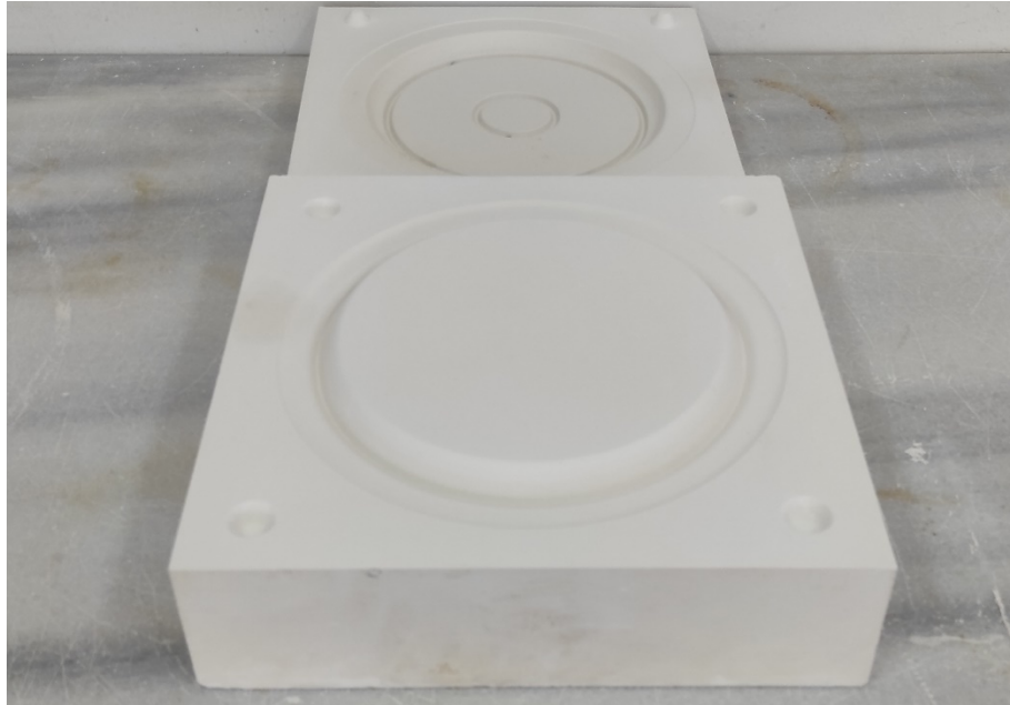
Görsel 3.79. Tamamlanan dişi ve erkek servis tabağı kalıbı Ali Öncel fotoğraf arşivi
