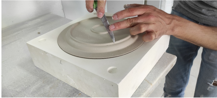
Görsel 3.87. Dökümden sonra servis tabağı kalıbının açılması Ali Öncel fotoğraf arşivi
