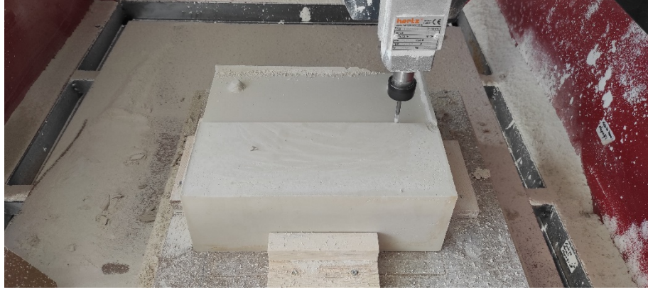
Görsel 3.62. Salata kasesi diři kalıbın kaba kazıma işlemleri Ali Öncel fotoğraf arşivi
