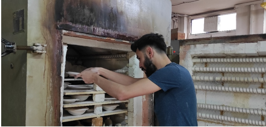
Görsel 3.96. Rötuşlanan yarı mamul ürünlerin fırına yerleştirilmesi Ali Öncel fotoğraf arşivi
