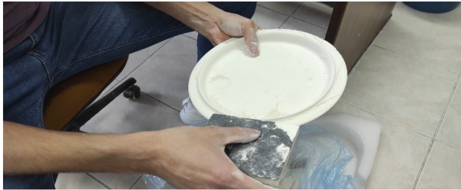
Görsel 3.94. Servis tabağının rötuşlanma işlemi Ali Öncel fotoğraf arşivi
