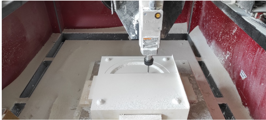
Görsel 3.75. Servis tabağı dişi kalıp kaba kazıma işlemi Ali Öncel fotoğraf arşivi
