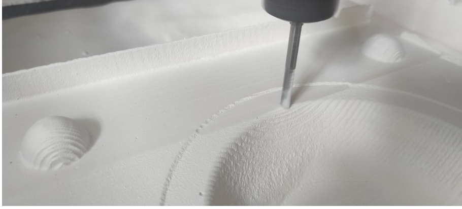
Görsel 3.50. Çorba kasesi dişi kalıp kaba kazıma işlemi detay Ali Öncel fotoğraf arşivi
