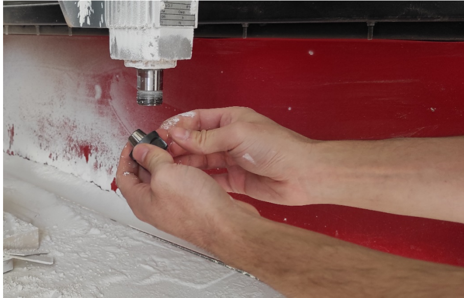
Görsel 3.38. Cnc freze ucın pense geçirilme işlemi Ali Öncel fotoğraf arşivi
