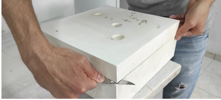
Görsel 3.86. Dökümden sonra kalıpların açılması Ali Öncel fotoğraf arşivi
