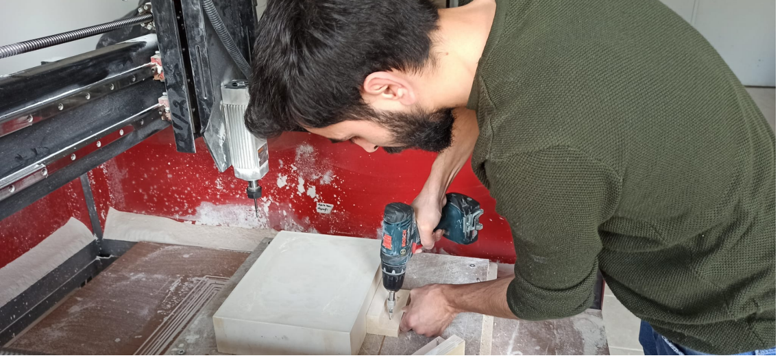
Görsel 3.36. Kazınacak alçı kalıp bloğun cnc tezgahına sabitlenmesi Ali Öncel fotoğraf arşivi
