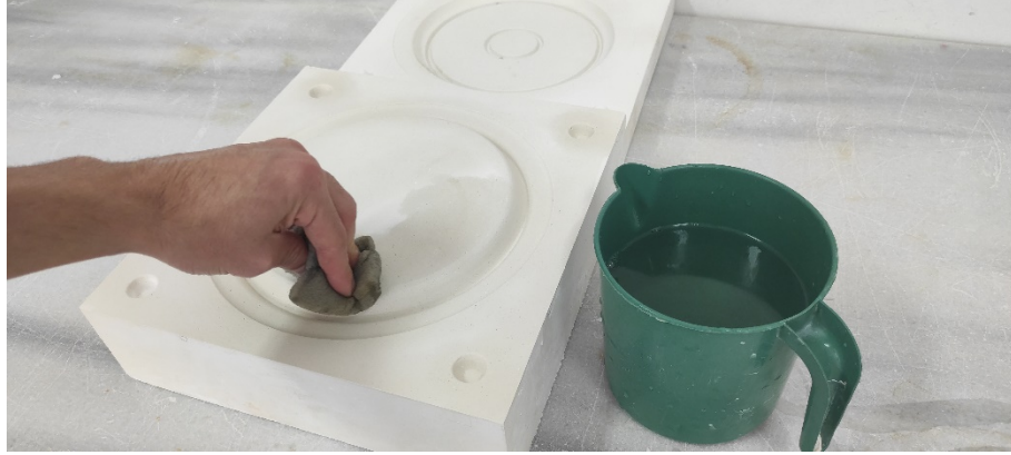
Görsel 3.80. Kalıpların nemli sünger ile temizlenmesi
