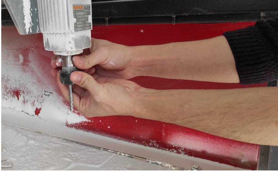
Görsel 3.39. Freze ucun takılı olduğu pensi Spindle motora bağlama işlemi Ali Öncel fotoğraf arşivi
