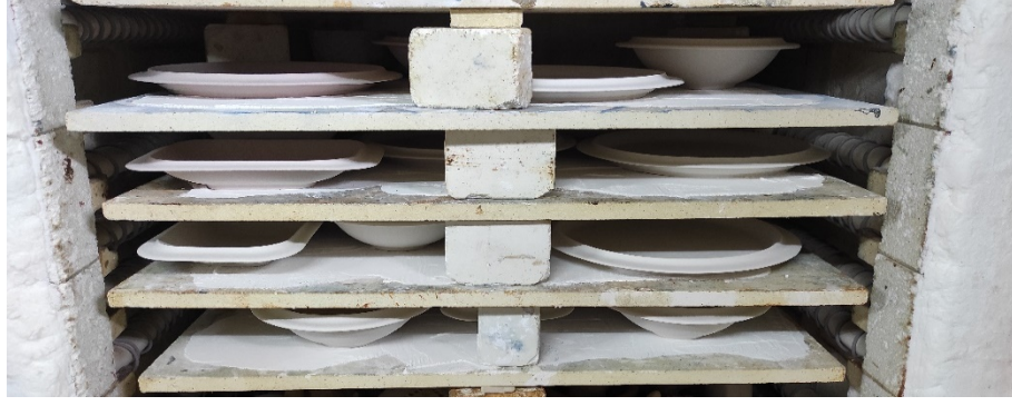
Görsel 3.97. Rötüşlenen yarı mamul ürünlerin fırına yerleştirilmesi
