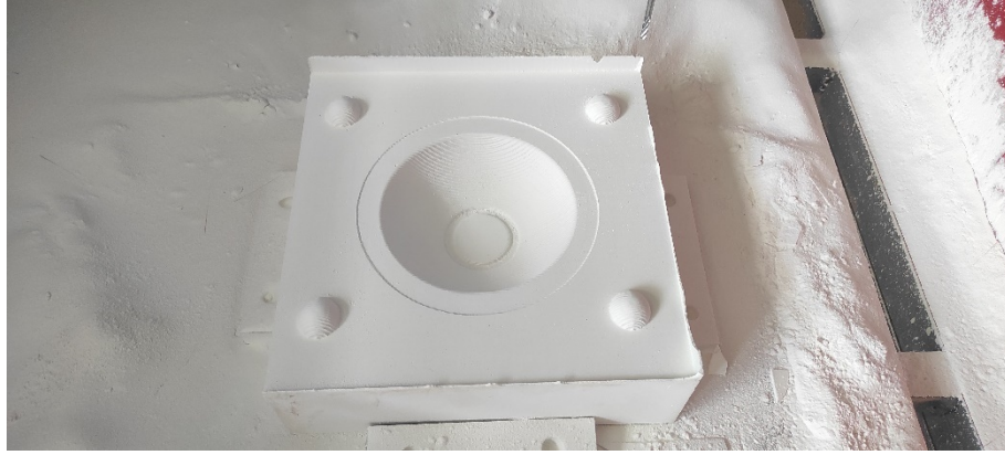
Görsel 3.53. Kaba kazıma işlemi tamamlanmış çorba kasesi dişi kalıbı Ali Öncel fotoğraf arşivi
