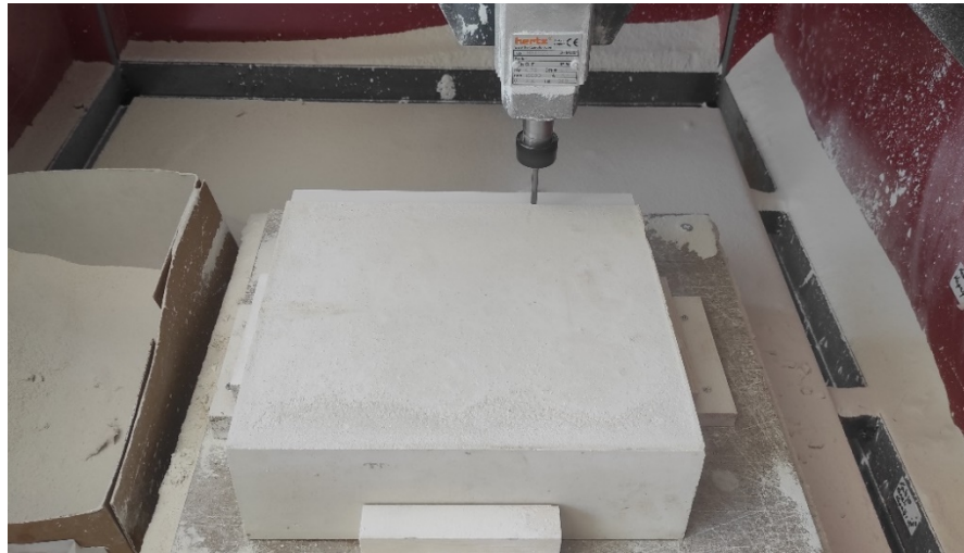
Görsel 3.68. Servis tabağı erkek kalıbın kaba kazıma işlemi Ali Öncel fotoğraf arşivi
