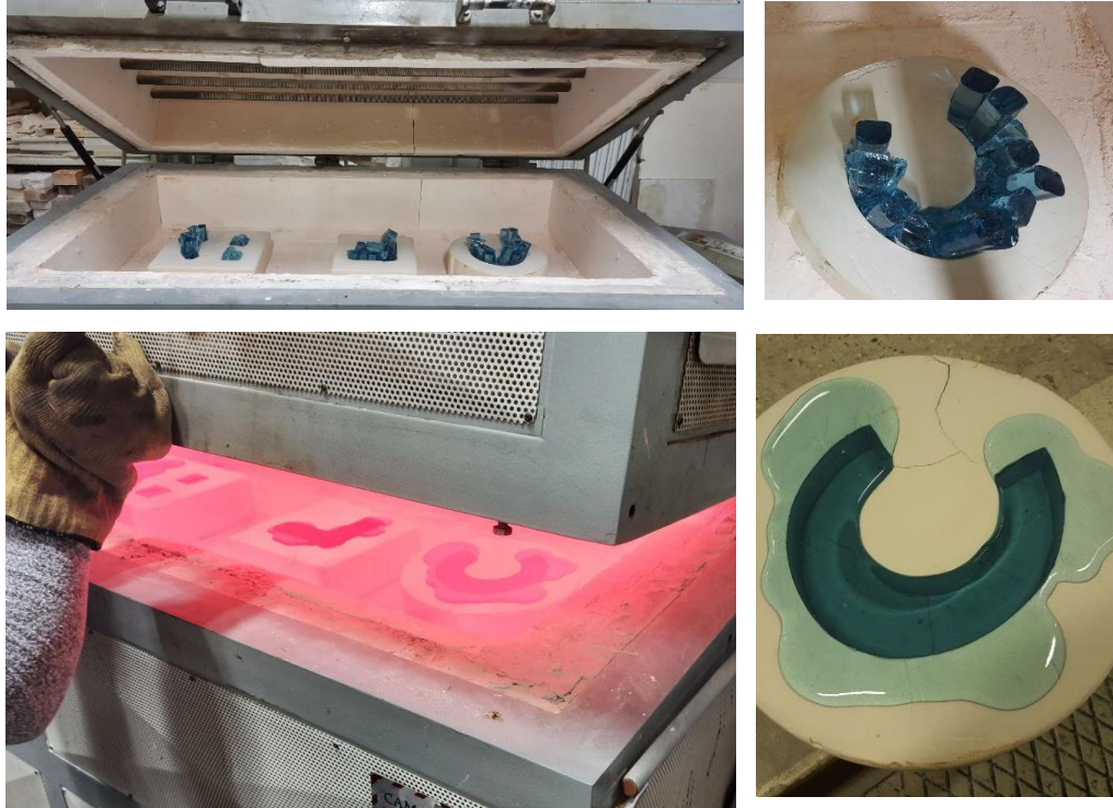
Görsel 4.5. Camların kalıba yerleştirilmesi ve fırınlanması
