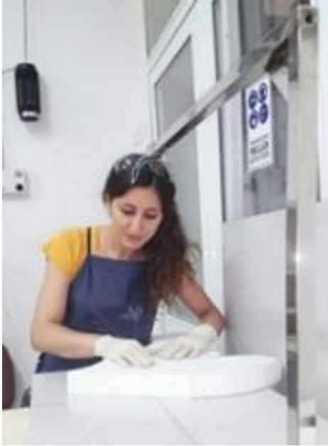
Görsel 4.2. Strafor kesme cihazında model kesimi
