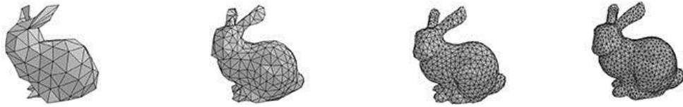
Görsel 2.4. Düşük poligon ve yüksek poligon örneği
