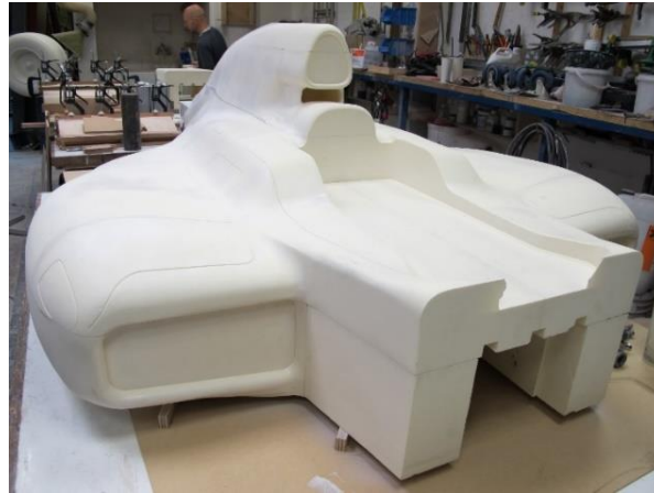
Görsel 2.6. Cnc prototiplendirme örneği
