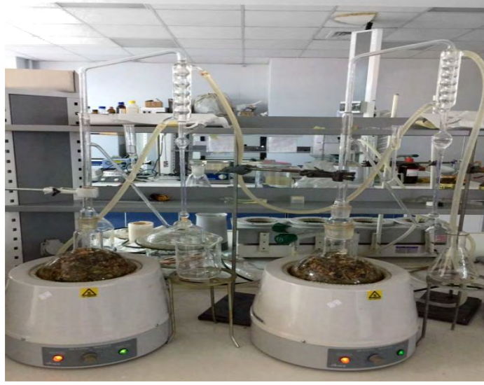
Görsel 3.6. Salvia sclarea 'nın toprak üstü kısımlarından uçucu yağ eldesi
