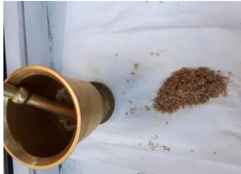
Şekil 3.4. L. cuminoides meyve kısımlarının ekstraksiyona hazırlanması
