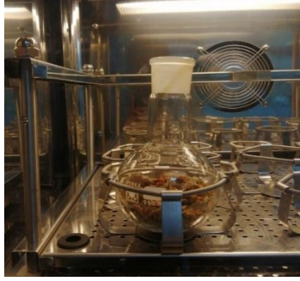
Şekil 3.5. Bitkisel materyalin (meyve) \text{CHCl}_3:\text{CH}_3\text{OH} (2:1, h/h ) ile çalkalayıcıda maserasyonu
