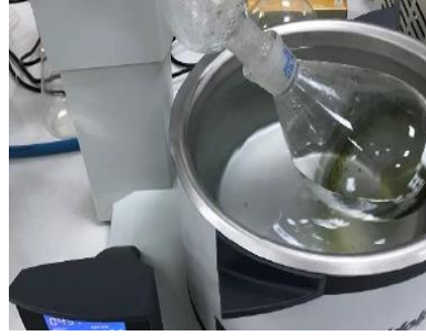
Şekil 3.9. Ekstrelerden rotavapor ile çözücü uzaklaştırma işlemi
