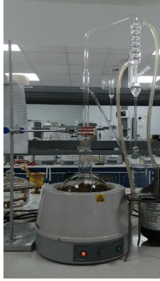
Şekil 3.3. Bitkisel materyalin (meyve) Clevenger apareyinde hidrodistilasyonu
