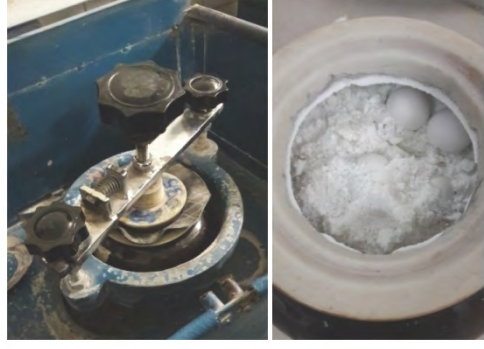
Şekil 8.4. (a) Transparan fritin öğütme işleminde kullanılan makine ve (b) seramik kap
