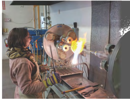
Şekil 4.5. Tornada boru cam şekillendirme
