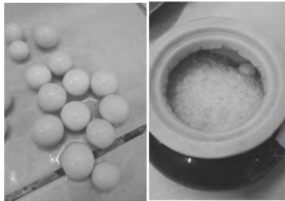
Şekil 8.3. (a) Transparan frit için öğütme işleminde kullanılan seramik toplar ve (b) seramik kap
