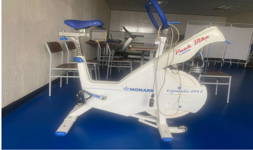
Görsel 3.5. Wingate anaerobik güç testi bisikleti
