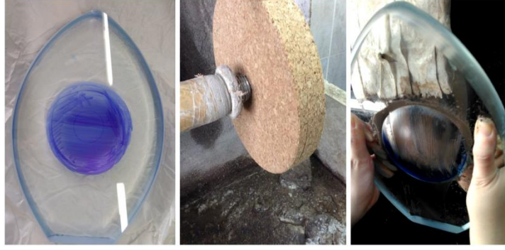
Şekil 7.57. Parlatma işleminin mantar kafalarda gerçekleştirilmesi işlemi
