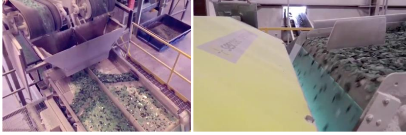
Şekil 5.8. Camların kırılma işlemleri
