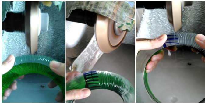
Şekil 7.33. Açılı elmas profilinde doku verilmesi işlemi
