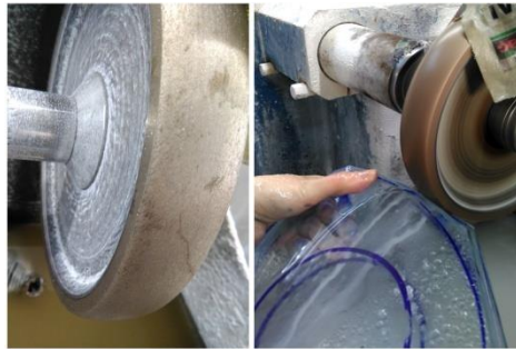
Şekil 7.50. 46 Gritlik elmas aşındırıcı (a) ile camın kenarlarında işaretlenen çizgi hizasına düşürülme işlemi (b)
