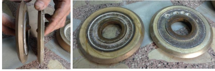
Şekil 3.10. Açılı elmas disk profili
