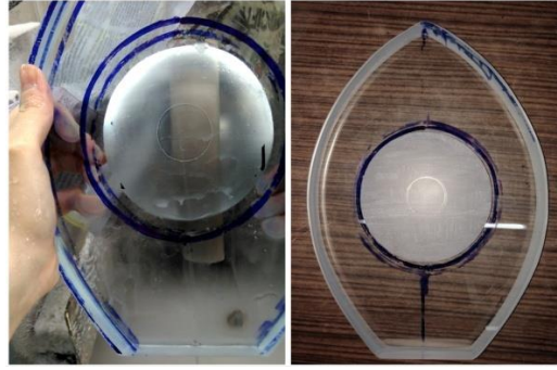
Şekil 7.51. Tasarımın gövdesindeki dairenin 46 gritlik elmas aşındırıcı ile aşındırılması işlemi
