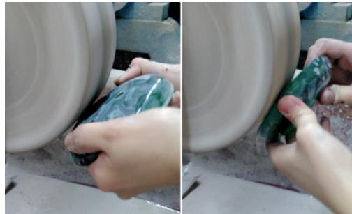
Şekil 7.38. Camın seryum işlemine tabi tutulması
