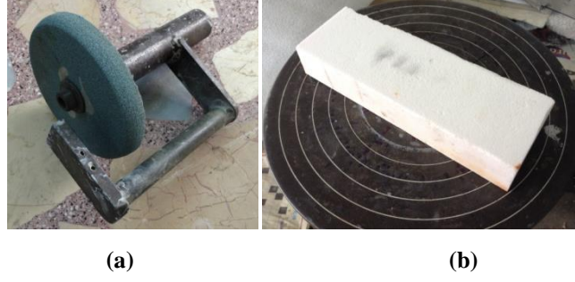
Şekil 3.13. Kaba taneli aşındırıcı bileme taşı (a) Şekil 3.14. İnce taneli aşındırıcı bileme taşı (b)
