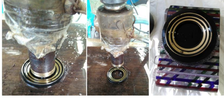
Şekil 7.20. Fotoğraf makinesi lensinde kullanılacak camın matkap yardımı ile delinmesi Fotoğraf: Özge Biçer tarafından çekilmiştir
