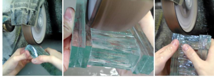
Şekil 7.5. Kaba elmas aşındırıcıda camın istenilen forma getirilmesi aşamaları
