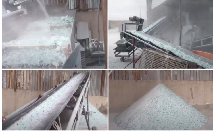
Şekil 5.14. Cam ambalaj atıkların titreşimli kırıcılar tarafından kırılması
