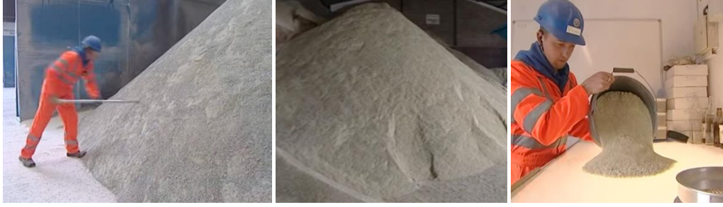
Şekil.5.18. Öğütülen camlardan alınan örneğin (a), laboratuvarında incelenmesi (b)
