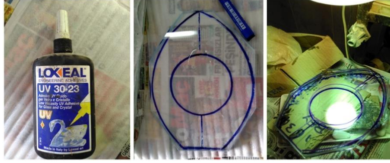
Şekil 7.49. Camların UV Yapıştırıcı (a) ile yapıştırılması (b)
