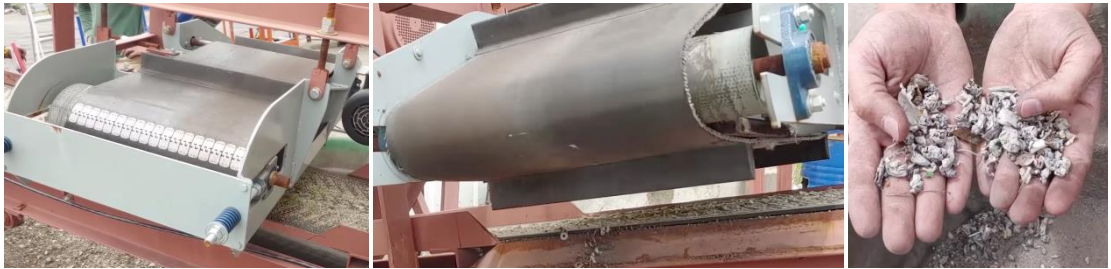
Şekil 5.7. Manyetik tutucular (a) ile kırılan cam arasından yabancı madde ayırıştırma işlemi (b)
