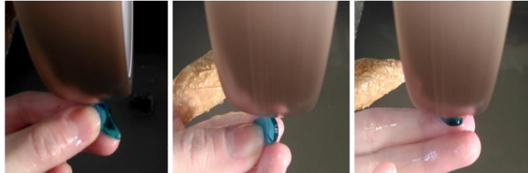
Şekil 7.59. Kesilen füzyon camlarının 46 gritlik elmas taşında şekillendirilmesi
