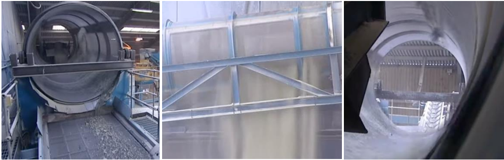
Şekil.5.17. Atık camların döner tamburlarda ince öğütülmeleri
