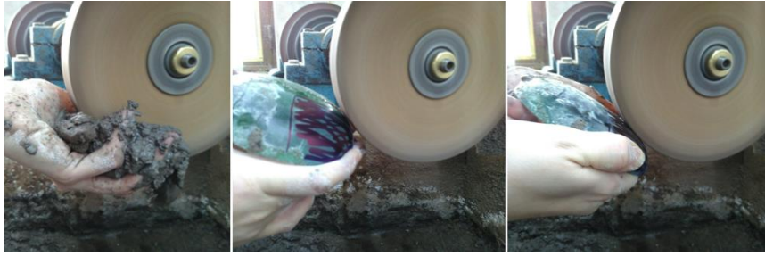
Şekil 7.37. Camın parlatılma işleminin uygulanması
