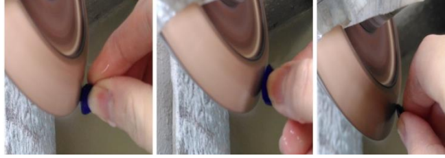
Şekil 7.60. Şekillendirilme işlemi yapılmış camlara pah alma işleminin uygulanması
