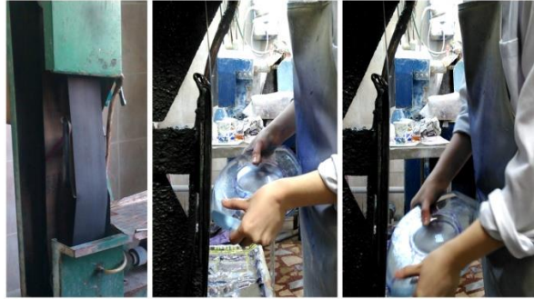
Şekil 7.54. 120 gritlik şeritte camın kenarlarındaki kaba elmas taşının aşındırma izlerinin alınması
