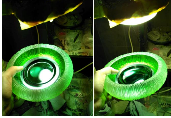
Şekil 7.39. Camın UV lambası altında UV yapıştırıcı ile yapıştırılması işlemi Fotoğraf: Özge Biçer tarafından çekilmiştir
