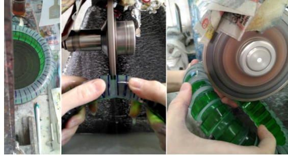
Şekil 7.44. 600 gritlik elmas aşındırıcı ile 46 gritlik elmas taşının bıraktığı izler temizlenmiştir
