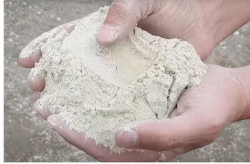
Şekil. 5.13. 0,8 İnçlik elekte öğütülen cam
