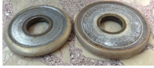
Şekil 3.9. Oval elmas disk profili
