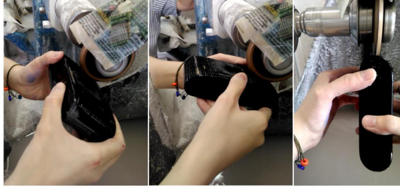
Şekil 7.16. Açılı elmas profilinde, fotoğraf makinesi üzerine çizgisel desenlerin uygulanması
