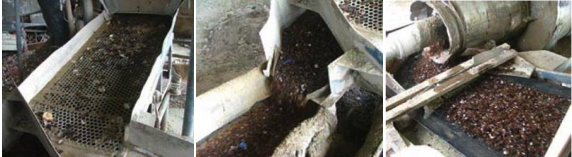
Şekil 5.15. Cam atıkların eleme (a) ve yıkanması aşaması (b), (c)
