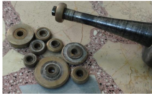
Şekil 3.12. Dikey disklerin farklı boyut profilleri
