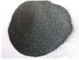
Şekil 3.2. “Karborundum” Silisyum Karbür
