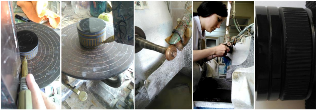
Şekil 7.17. Çizim işlemi yapılan cam (a), en küçük açılı elmas profilinde şekillendirme işleminin yapılması (b)
