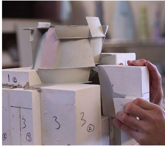
Görsel 3.14. Kyle Johns, alçı bloklardan oluşturduğu seramik döküm kalıbının açılma süreci ( https://ceramicartsnetwork.org/ceramics-monthly/ceramic-art-and-artists/ceramic-artists/slip-cast-vessel-experimentation/# ), (Erişim tarihi: 30 Mart 2021)
