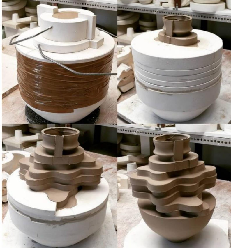
Görsel 3.33. Somchia Charoen, kırık kalıp tekniğinde alçının iç yüzeyi ile çamuru şekillendirme uygulaması ( https://www.instagram.com/somchaicharoen/ ), (Erişim tarihi: 1 Nisan 2021)
