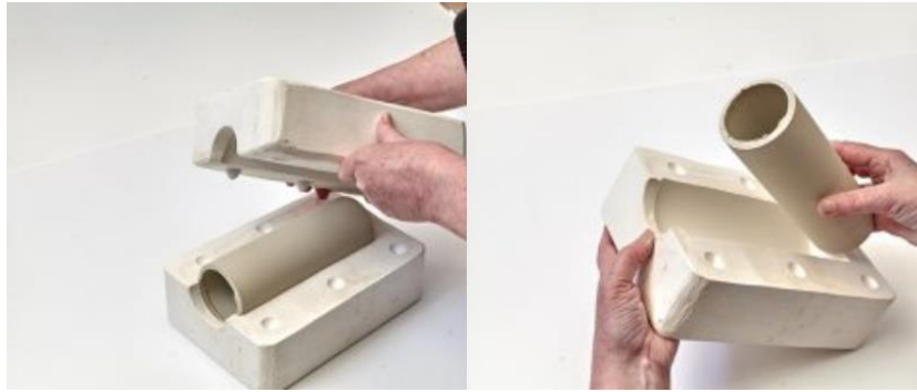
Görsel 2. 22. İki Parçalı vazo kalıbı ve uygulama örneği ( https://www.claycraft.co.uk/how-to/slip-casting-for-beginners/ ), (Erişim tarihi: 6 Mart 2021)
