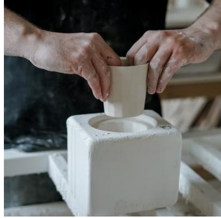
Görsel 2.21. Tek parçalı bardak kalıbı ve uygulama örneği ( https://thebrightangle.com/blogs/the-bright-angle-blog/slipcasting-design-and-handmade/ ), (Erişim tarihi: 7 Mart 2021)
