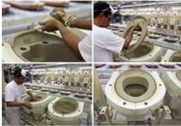
Görsel 2.24. Çok parçalı klozet kalıbı ve uygulama örneği ( https://www.designboom.com/design/laufen-factory-visit-ceramic-casting/ ), (Erişim tarihi: 7 Mart 2021)
