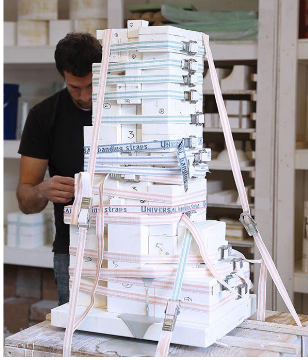
Görsel 3.13. Kyle Johns, alçı bloklardan oluşturduğu seramik döküm kalıbı ile uygulama süreci ( https://ceramicartsnetwork.org/ceramics-monthly/ceramic-art-and-artists/ceramic-artists/slip-cast-vessel-experimentation/# ), (Erişim tarihi: 30 Mart 2021)
