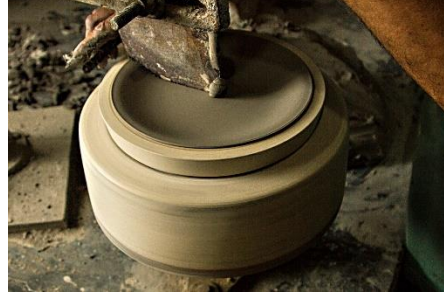
Görsel 2.26. Şablon torna ve uygulama örneği ( http://www.dsource.in/resource/ceramic-pottery-khurja/making-process ), (Erişim tarihi: 7 Mart 2021)
