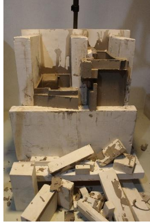
Görsel 4.2. “No.4 No.5 No.6” alçı bloklarının döküm sonrası çıkarılması (Arapoğlu, 2021)
