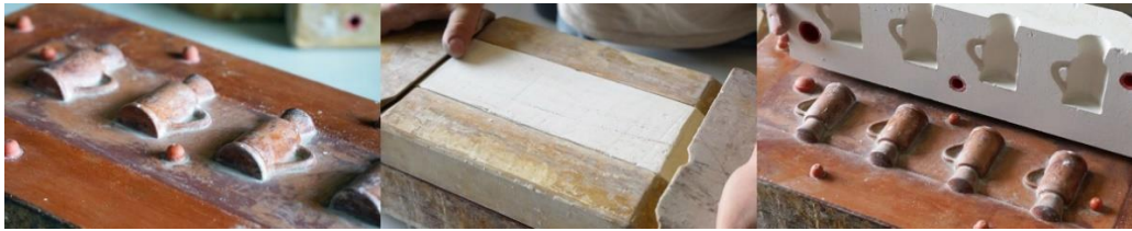
Görsel 2. 28. Teksir kalıbı ve uygulama örneği ( https://www.reutterporzellan.com/en/production/ ), (Erişim tarihi: 7 Mart 2021)
