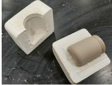
Görsel 2.25. Patlatma kalıbı ve uygulama örneği ( https://www.137degrees.com/en/courses/mold-making-and-slip-casting-workshop/ ), (Erişim tarihi: 7 Mart 2021)
