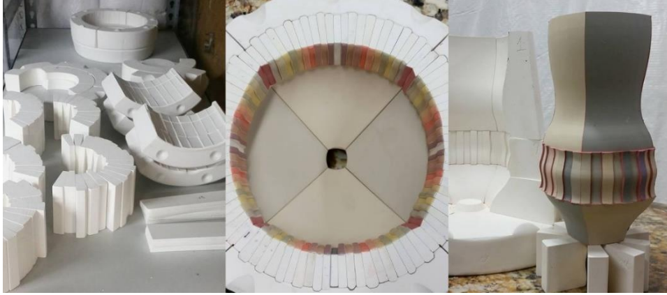
Görsel 3.24. Peter Pincus, çok parçalı alçı kalıpları düzenleme ve eser üretim süreci ( https://www.instagram.com/peterpincusporcelain/ ), (Erişim tarihi: 30 Mart 2021)
