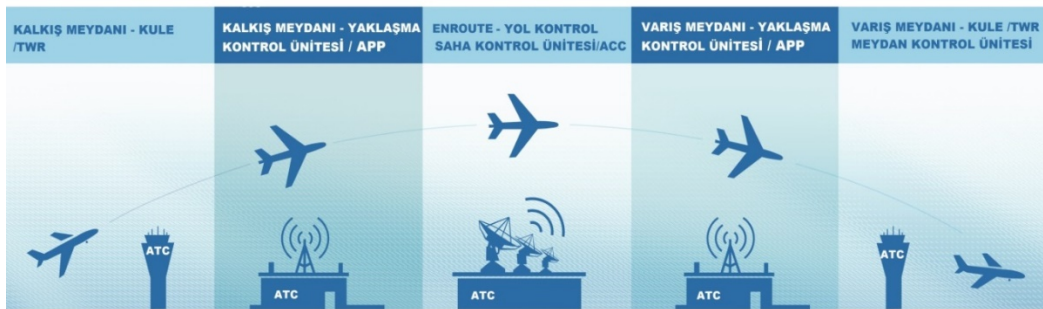
Şekil 1.1. Hava trafik üniteleri arası ve HTK-Pilot koordinasyonu ile hava aracının noktadan noktaya uçurulması (American Airlines Newsroom, http1 ,2019 ) adresinden uyarlanmıştır.
