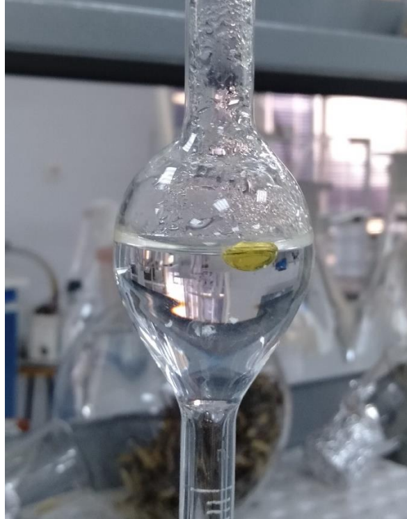
Görsel 3.3. Kimyon meyve uçucu yağının Clevenger aparentinde toplanmış hali Foto: (S. Candar.)
