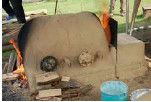
Görsel 13. Balçık haline getirilmiş topraktan yapılmış fırın.
