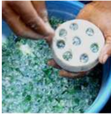
Görsel 10. Yarı şeffaf cam boncuk kalıplarının cam kırıklarıyla doldurulması.
