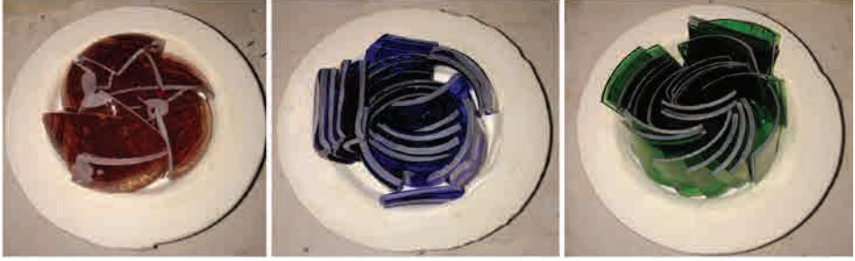
G. 7. Camların kalıplara yerleştirilmesi ve fırına konulması (Özge Biçer, 2018)
