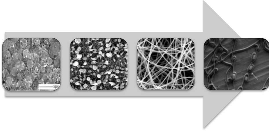
Şekil 2.11. Elektro çekim sırasında artan derişim ile elde edilen yapıların SEM görüntüleri [67,71,72]
