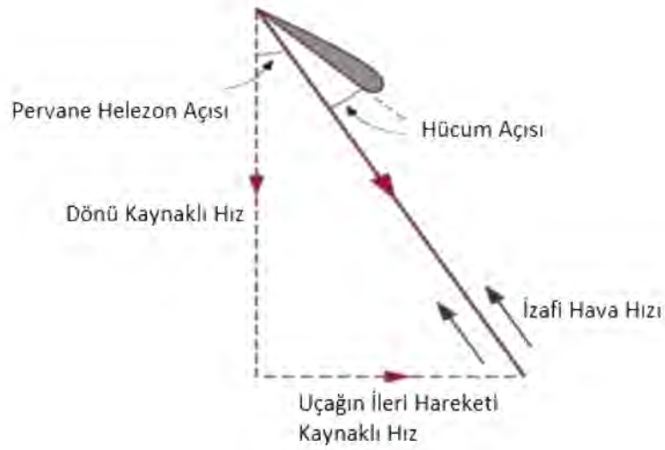
Şekil 4.3. Pervane Üzerinde Oluşan Bileşke Hız ( http-12 'den uyarlanmıştır)
