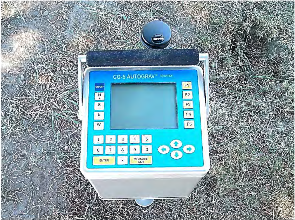
Şekil 2.18: Scintrex CG-5 otomatik gravimetre cihazı (Scintrex, 2006)
