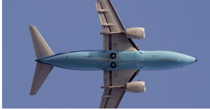
Görsel 4.5. Boeing 737'nin iniş takımları kapalı durumu ( http-12 )
