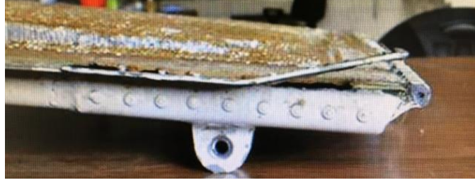
Görsel 4.9. A/I/T iç kapağındaki çatlak
