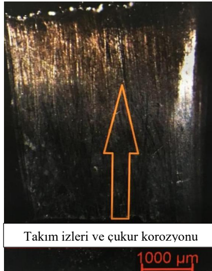
Görsel 4.45. Takım izleri ve çukur korozyonu
