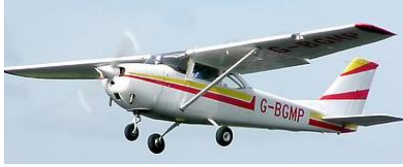
Görsel 4.1. Cessna 172 ve sabit iniş takımları ( http-8 )
