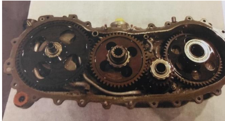
Görsel 4.23. Aksesuar dişli kutusu iç görünümü
