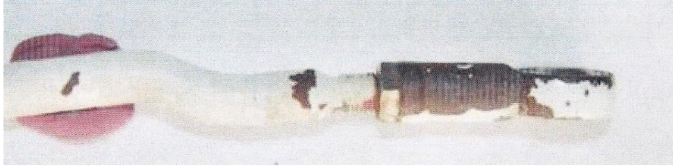
Görsel 4.19. Rod asamblesindeki deformasyon
