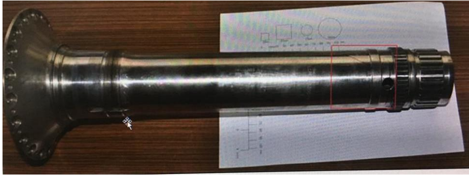
Görsel 4.42. Hasarlı kompresör şaftı
