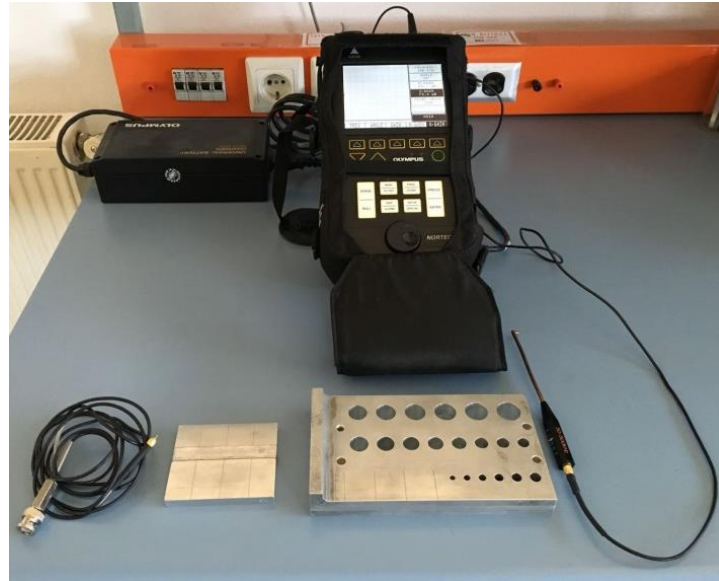
Görsel 3.26. Portatif bir girdap akım test cihazı
