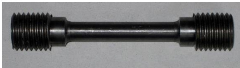
Görsel 3.21. Sürünme deneyi öncesinde test numunesi (Chvostova and Dzugan, 2017)
