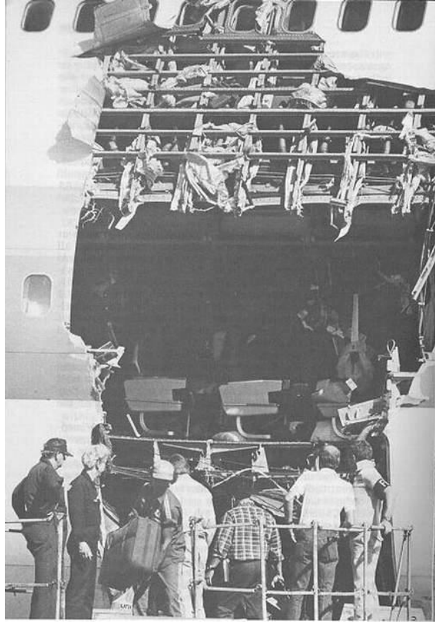
Görsel 1.1. İniş sonrasında uçaktaki hasarlı bölge ( http-2 )
