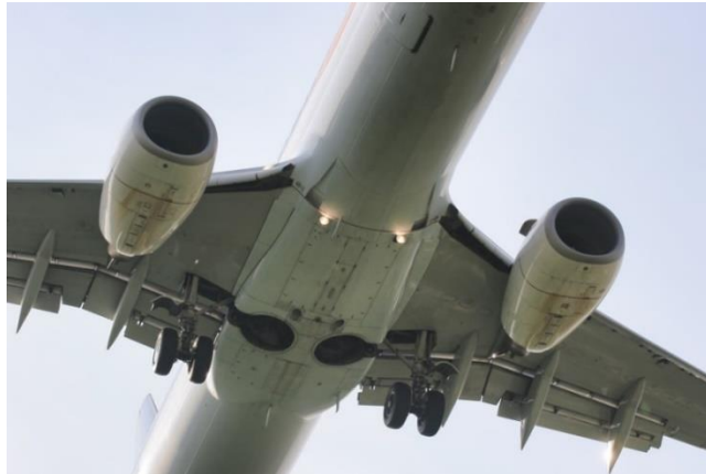
Görsel 4.4. Boeing 737'nin iniş takımları açık durumu ( http-11 )
