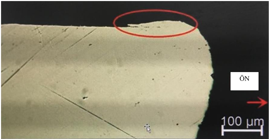
Görsel 4.40. Dovetail yuvasında meydana gelen çapaklanma
