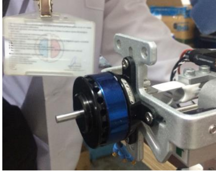
Şekil 5.11. Deney düzeneği fırçasız DA motorunun monte edilmiş hali
