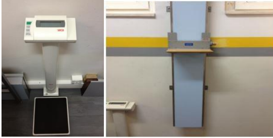
Görsel 3.1. Laboratuvar baskülü ve sabit stadiometre
