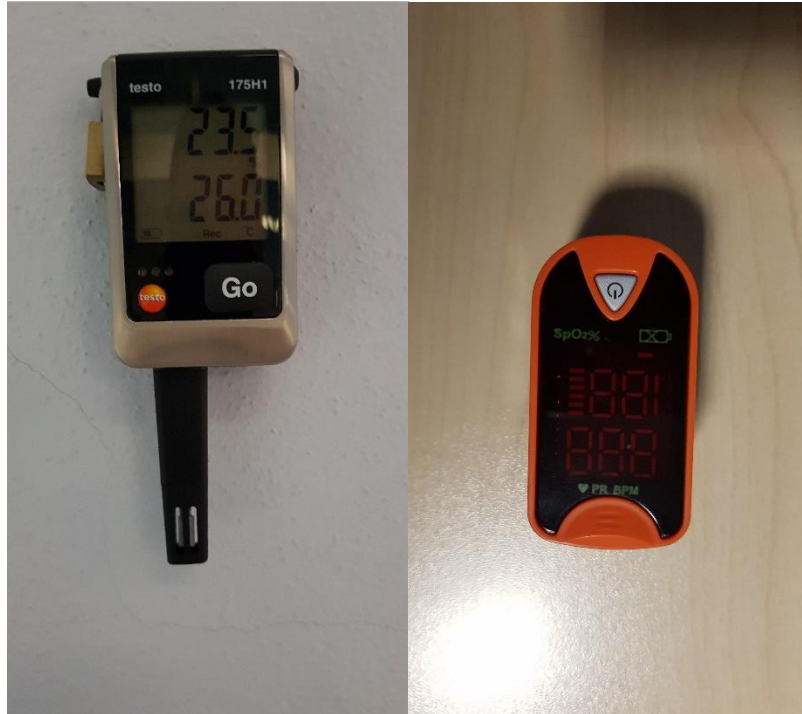
Görsel 3.11. Sıcaklık, nem ve oksijen saturasyonu cihazları
