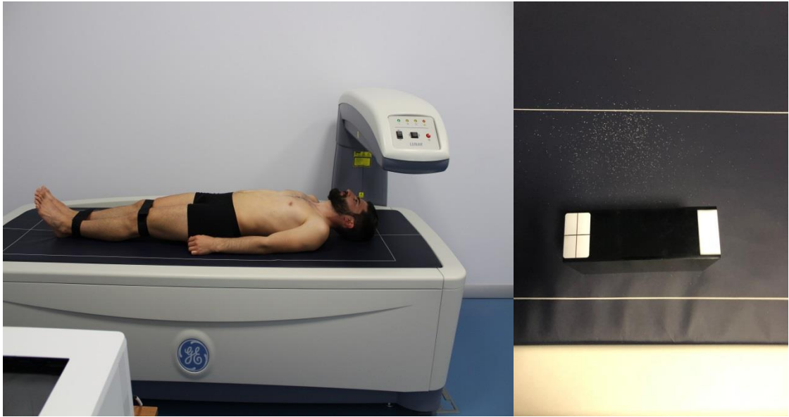
Görsel 3.2. Kemik yoğunluğu ölçüm cihazı ve kalibrasyon bloğu
