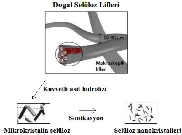
Şekil 2.7. Asit hidrolizi yöntemiyle selülozdan nanoselüloz üretimi [37]
