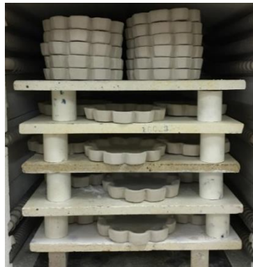
Görsel 3.5. Ham Plakaların Bisküvi Pişirimi İçin Fırına Yerleştirilmesi (Öztürk Razi,2018)
