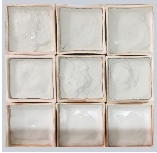
Görsel 3.1. Öğütülen Pencere Camı Atığının Kalsine Kaplarında Kurutulması (Öztürk Razi,2018)
