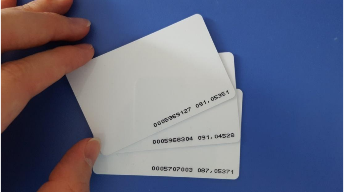
Şekil 4.23 Sistemde kullanılan RFID kartlar (Proximity Tipi)
