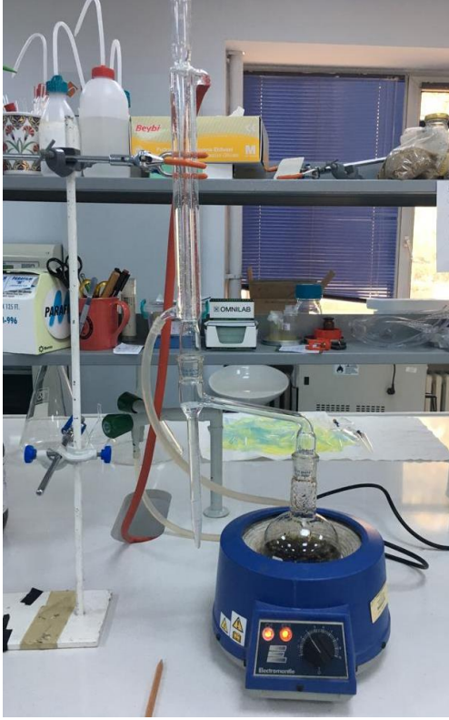
Görsel 3.2. Avrupa Farmakopesi'nde tanımlanan volumetrik su miktar tayini apareyi
