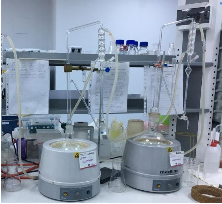
Görsel 3.3. Clevenger aпараты (Avrupa Farmakopesinde tarif edilen)
