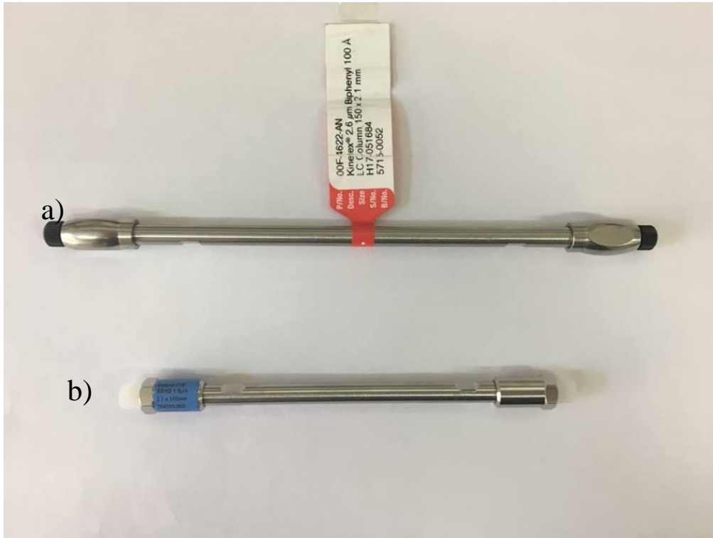
Şekil 3.2. a) OTA-CIT-ZEA deneylerinde kullanılan UHPLC kolonu, b) CTV deneylerinde kullanılan UHPLC kolonu
