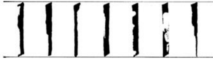
Görsel 68. Kalem ucu açısının yanlış olduğunda kağıt üzerinde ortaya çıkan sorunlar
