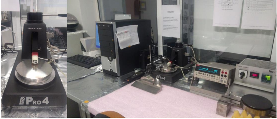
Şekil 3. 1. \text{VO}_x ince filmlerin elektriksel özelliklerine ilişkin ölçümlerin yapıldığı dört nokta iğne sistemi (Anadolu Üniversitesi İleri Teknoloji İnce Film Laboratuvarı)
