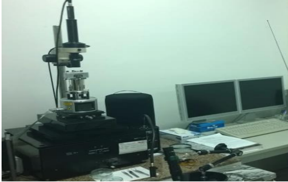
Şekil 4.7. Atomik Kuvvet Mikroskobu (Anadolu Üniversitesi, İleri Teknoloji İnce Film Laboratuvarı)
