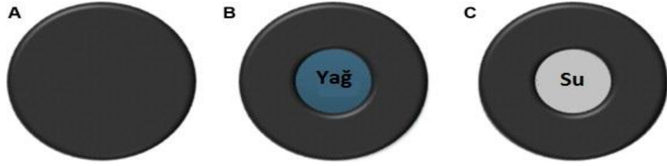
Şekil 1.6. Yağ (B) ve su (C) nano kapsüller ve polimer nanopartikül nanokürelerin (A) gösterimi
