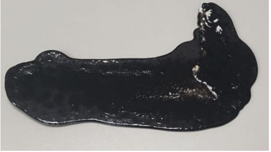
Şekil 5.1. Eriyik ani soğutma yöntemi ile üretilen camı 14\text{Li}_2\text{O}:9\text{Al}_2\text{O}_3:38\text{TiO}_2:39\text{P}_2\text{O}_5 levha. Beyaz bölgeler soğuma esnasında meydana gelen kristallenmelerdir
