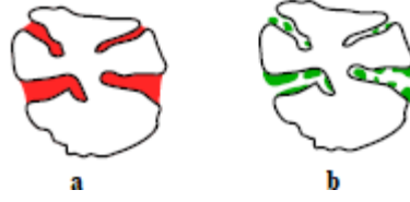
Görsel 4. 2. Islak emdirme sırasında gözeneklerde aktif faz birikimi (a) ve sonrasında uygulanan kurutma işleminin etkisi (b) (Ross, 2012)
