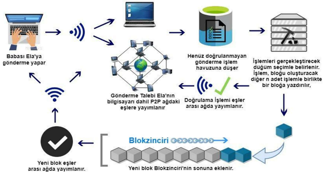
Şekil 3.1 Blokzinciri Sisteminin Çalışma Prensibi
