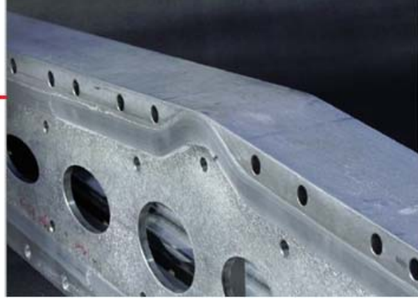
Şekil 8. A-380 uçağının FSW uygulanmış bir flap track'i.
