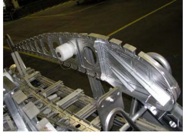
Şekil 7. A-380 uçağının FSW uygulanmış bir flap profili.
