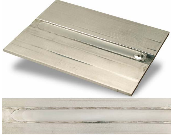
Şekil 1. FSW yöntemi ile birleştirilmiş iki levha [5].
