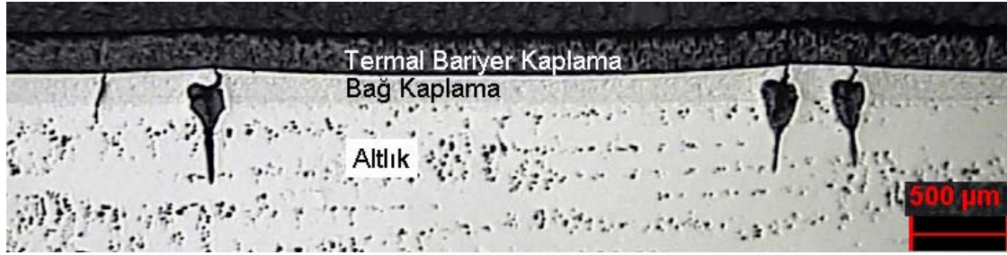
Şekil 6. A2 numaralı numunede saptanan çatlaklardan bazıları
