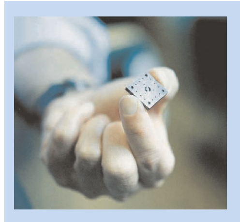
Şekil 16. Bir yonga tabanlı türbinin prototipi [21].
