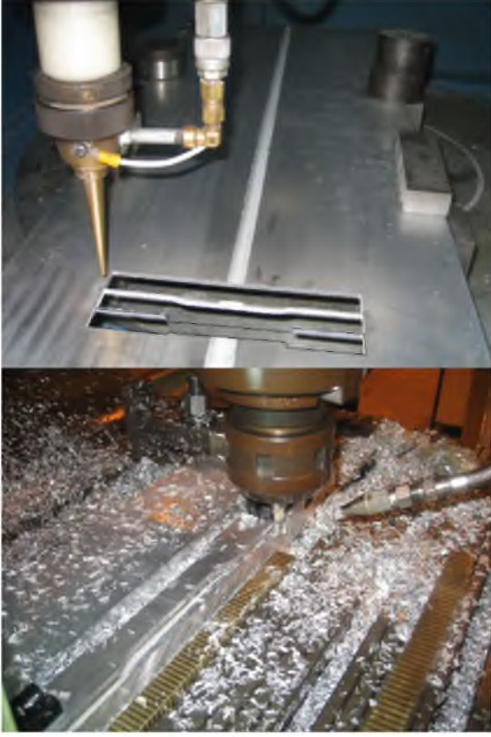
Şekil 7.b. Çekme ve yorulma numunelerinin lazerle kesilmesi ve frezede işlenerek hazırlanması.
