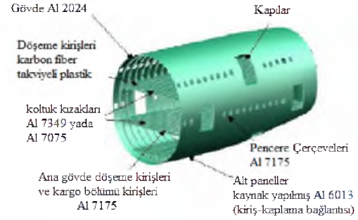
Şekil 2. Airbus 380 yolcu uçağı yapısında alüminyum alaşımların kullanım yerleri. [11]
