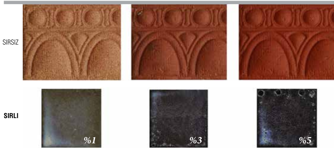
Resim 5. Fe 2 O 3 Katkılı Bünyelerin Sırsız ve Sırlı Pişme Renkleri, 1200°C
