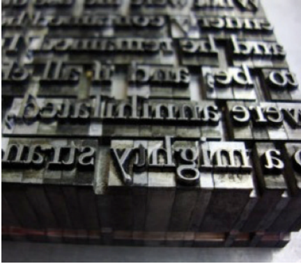
Görsel 3: Tipo baskı tekniğinde kullanılan metal harfler
