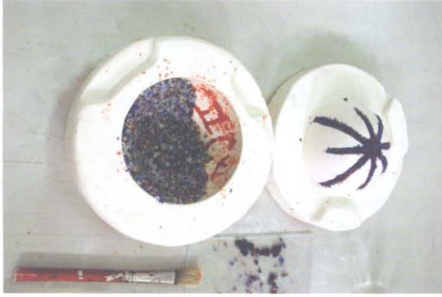
Resim 2. Kalıp yüzeyindeki çukur kısımların doldurulması işlemi bittikten sonra iskeleti oluşturan ana kısım şekillendirilmesi.
