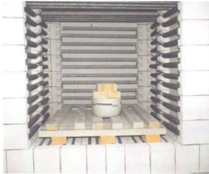
Resim 5. Kalıbın fırın içerisindeki görünüm.
