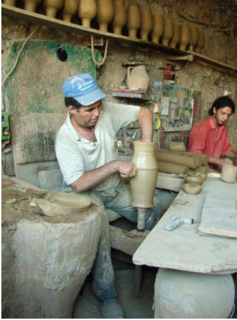
Resim 16: Nevşehir İli Avanos İlçesinde Kullanılan Elektrikli Torna, Mustafa Yazıcı Atölyesi,
